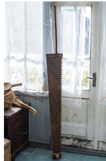
Šķērszāģis – baļķu zāģēšanai šķērsvirzienā (atrodas senlietu krātuvē "Lauksargi")
